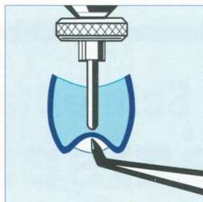
Messen der Wandstärke Measuring of wall thickness Mesure de l'épaisseur de paroi Medición del espesor de la pared
